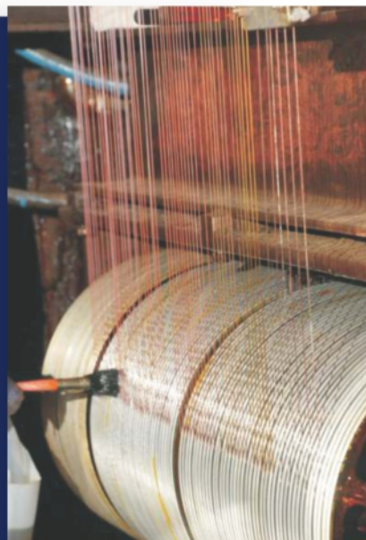
Proceso de esmaltado en alambre magneto
