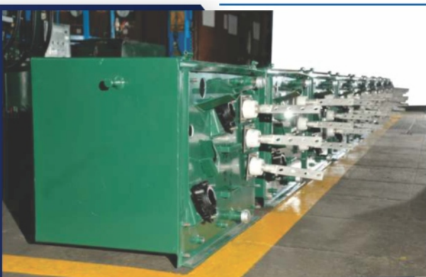
Colocación de accesorios al transformador
